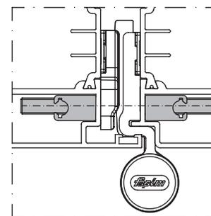
Monaco è disponibile in diverse versioni, tutte complete di kit fissaggio, sviluppate secondo le caratteristiche del profilo utilizzato.
