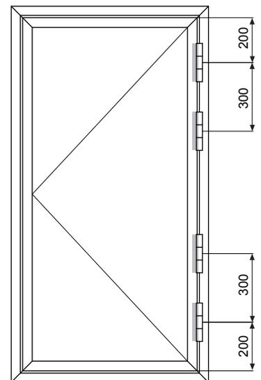
Monaco garantisce una portata fino a 180 Kg, superando con due cerniere i 5 milioni di cicli nei severi test interni, la portata si alza a 210 Kg con tre cerniere e 240 Kg con quattro. Monaco è certificata CE in conformità alla norma UNI EN 1935:2002/AC:2003.
